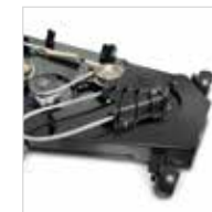
PLATEAU DE COUPE MÉCANO-SOUDÉ (XT2 QS117)
